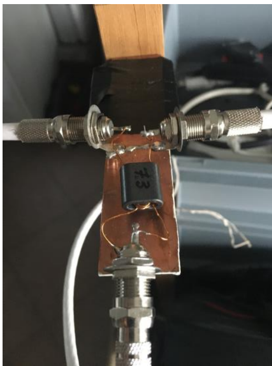
Particolare del trasformatore e relative connessioni
