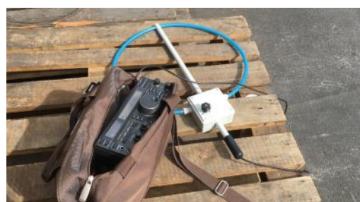
Kit per individuazione dei disturbi di IU2IBU
