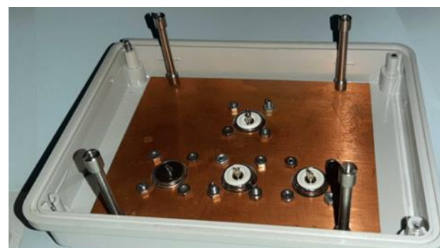
Pannello della cassetta con i connettori montati
