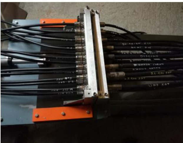
Figura 1. Prototipo Antenna Breaker per 18 antenne.
